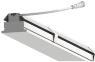
چراغ خطی توکار سروش به صورت سقفی، دیواری و دفنی قابل استفاده است. چراغ های خطی مدل سروش با درجه مقاومت در برابر رطوبت و گردو غبار (IP۶۵) مناسب برای نور پردازی خطی نما و فضاهای بیرونی بوده و به دلیل مقاومت ضربه ای بالا (IK۰۷) می توان در محل رفت و آمد نیز از آن استفاده نمود. پوشش این چراغ به طور کلی PMMA با نور کاملا یکنواخت می باشد. رنگ نور چراغ می تواند ۳۰۰۰-۶۰۰۰ کلوین، با توان ۱۲ وات بر متر، ضریب نمود رنگ  $CRI > 80$  و گام مک آدام می باشد.
